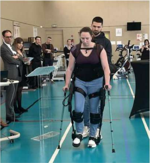
Les équipes du centre Pasteur ont présenté une partie du matériel, dont l'exosquelette, qui offre une assistance mécanique à la marche.
